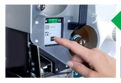
С помощью многоязычного сенсорного экрана можно получить доступ к часто используемым настройкам.
