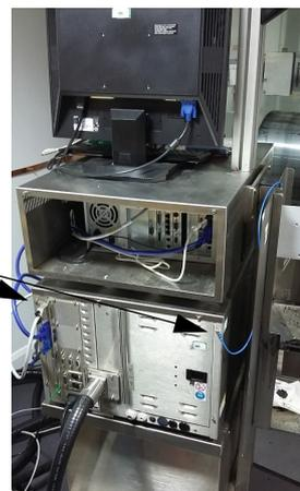
Концевое крепление M4 - закрепить на любом из болтов M4 в задней части корпуса.
