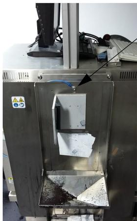
Концевое крепление M6 - закрепить на верху монтажного болта станции промывки.
