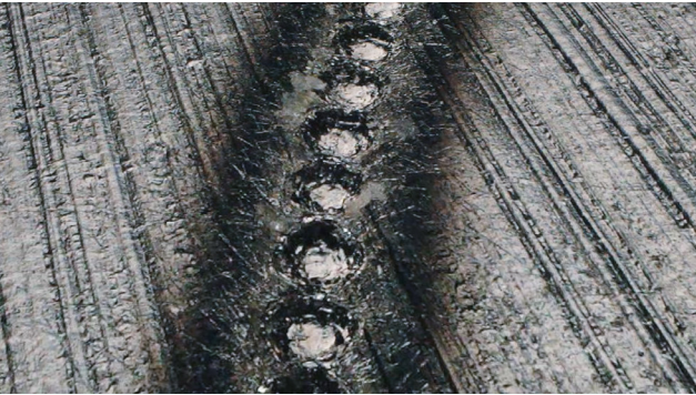
3D-зображення під мікроскопом показує окремі вигравіровані точки
