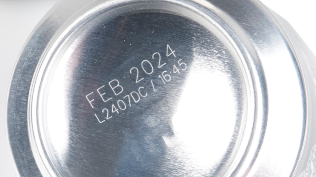
Лазерне гравірування дати та коду партії
