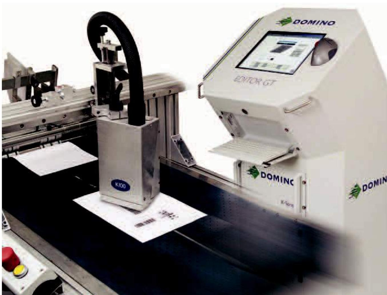
Принтер K100 с интуитивно-понятным редактором Domino Editor GT на основе Windows XP для работы с наносимой информацией. Терминал может быть выполнен в виде, указанном на фотографии выше, либо установлен на стандартный настольный компьютер.
